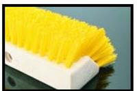
**Polipropileno:** Excelente resistencia química frente a ácidos, aceites, hongos y contra el crecimiento de bacterias. Proporciona una muy buena recuperación del curvado y resistencia a la abrasión. Resiste temperaturas de hasta 107°C. Opción ideal para ser utilizado en industrias alimenticias.
